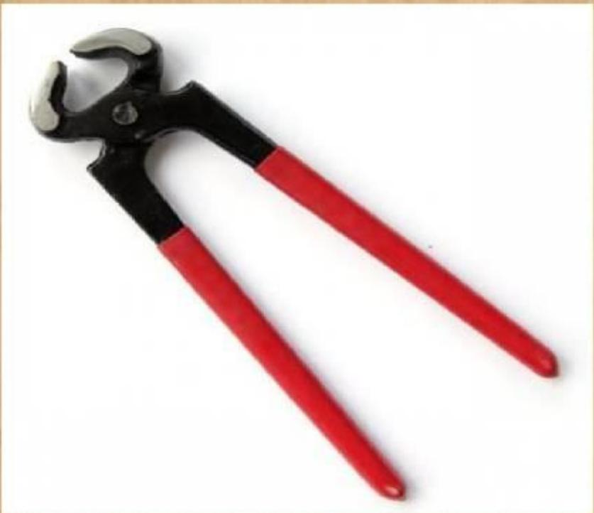
Кле́щи — инструмент в виде рычажных щипцов, обычно с длинными ручками, соединенными на шарнире, и короткими губками, смыкающимися на небольшом протяжении плоскими или заостренными поверхностями.
